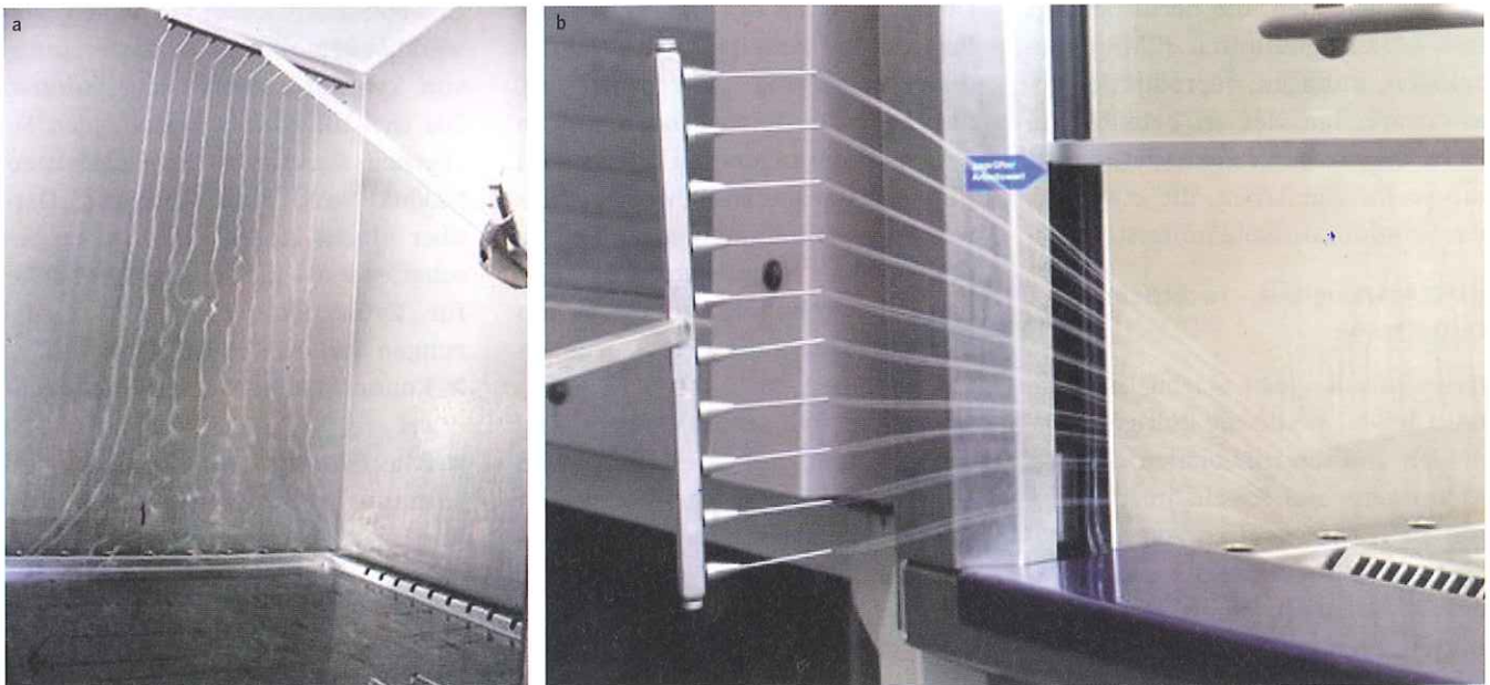
Abb. 1. Visualisierung der Luftströmungen in einer Sicherheitswerkbank.
