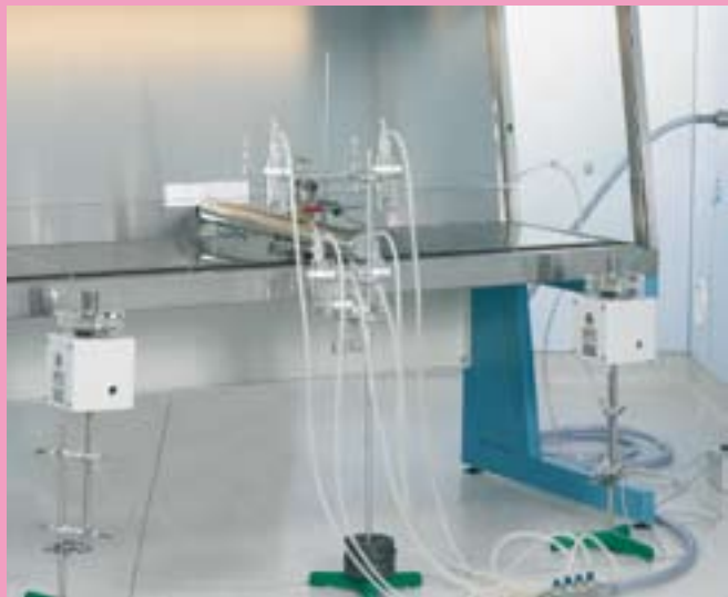
Abb. 2 Teststand mikrobiologische Prüfung des Personenschutzes.
